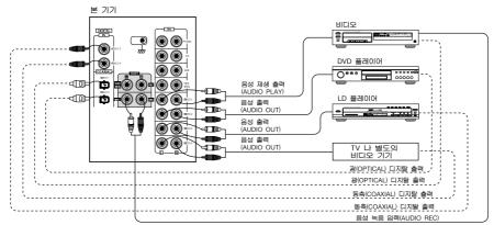
•본 기기에는 비디오 기기를 위한 연결단자중 디지털 입력 단자로는 광(OPTICAL)및 동축(COAXIAL)이, 영상단자로는 콤포넌트 (COMPONENT), S 및 일반(VIDEO) 영상 단자가 있습니다. 연결하려는 비디오 기기의 연결 단자에 따라 본 기기의 해당 비디오 (VIDEO 1~4)의 연결단자에 각각 연결합니다.
